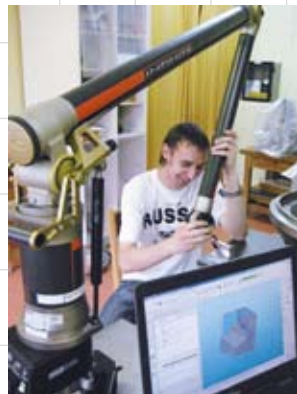
Рис. 19. Контроль оснастки при помощи КИМ Cimcore INFINITE 5036
