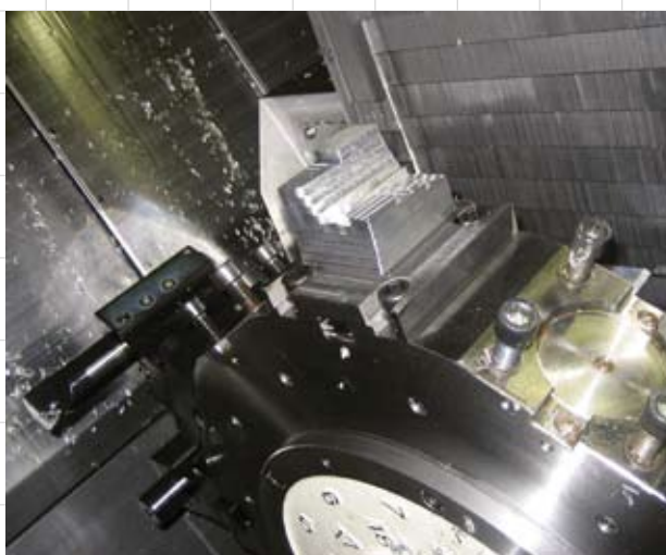
Рис. 15. Крепление заготовки на револьверном суппорте
