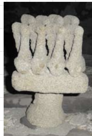
Рис. 23. Сформованная литейная система
