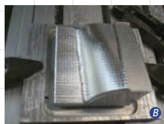
Рис. 9. Трехосевой фрезерный станок PAG 0501 (а) и спроектированная траектория обработки вставки (б) выпуклой литейной формы (в)
