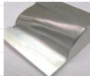
Рис. 10. Демонстрационный прототип вставки выпуклой литейной формы
