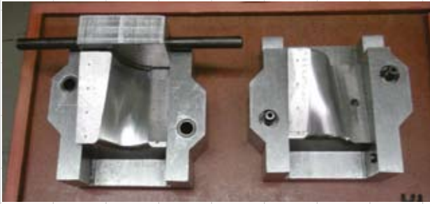
Рис. 17. Вставки: вогнутая (с присоединенной задней частью), и выпуклая (справа)
