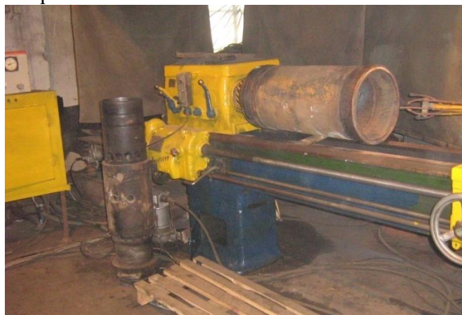
Рисунок 2 - Технологический комплекс по восстановлению внутренней поверхности гильз
