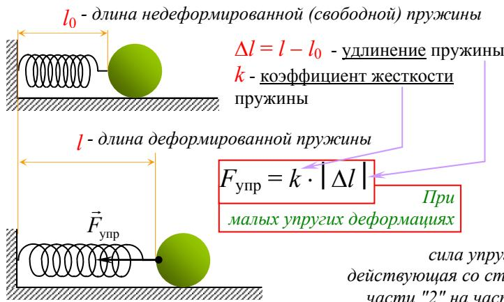
сила упругости, действующая со стороны части "2" на часть "1".
