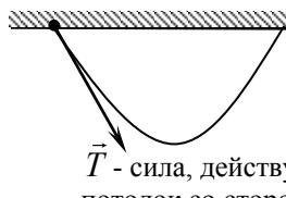
**T** - сила, действующая на потолок со стороны веревки, прикрепленной к нему.
