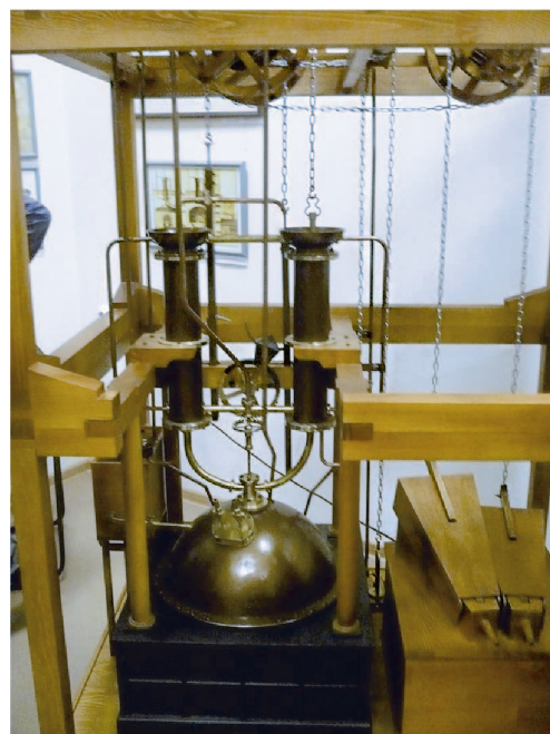
Рис. 5. Действующий уменьшенный образец паровой машины Ползунова
