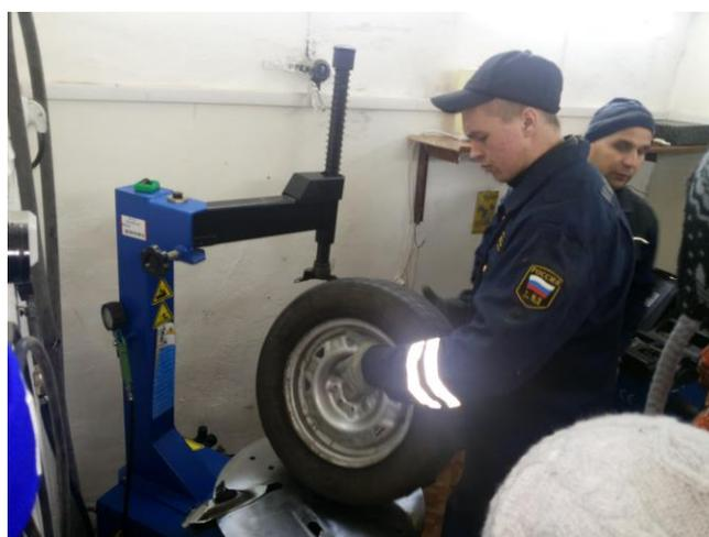
**Мастер - класс: "Ремонт и балансировка колеса легкового автомобиля"**
